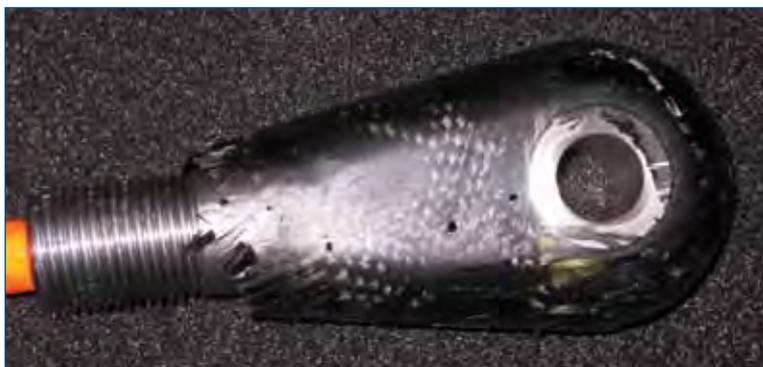
Bild 14: Seilendverbindung der vierten Generation
