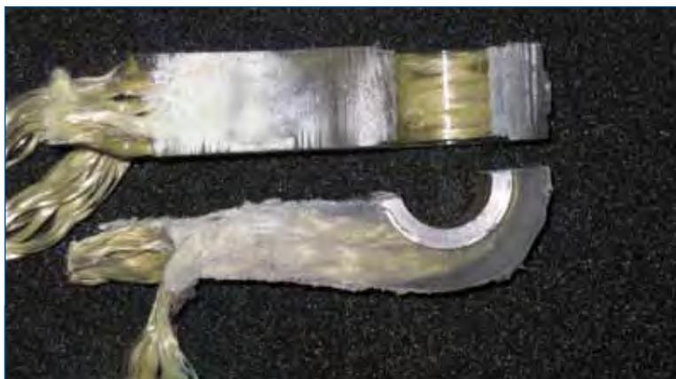
Bild 15: Schnitt durch die neuartige Seilendverbindung der dritten Generation
