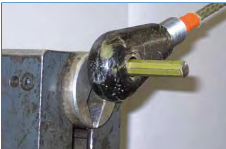
Bild 13 Aramidseil und neuartige Seilendverbindung der vierten Generation
