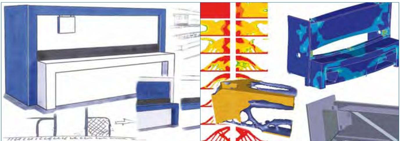
Bilder 1 bis 3: Am Anfang stand die Handskizze; dann folgten Topologieoptimierung und das gerenderte CAD-Modell.
