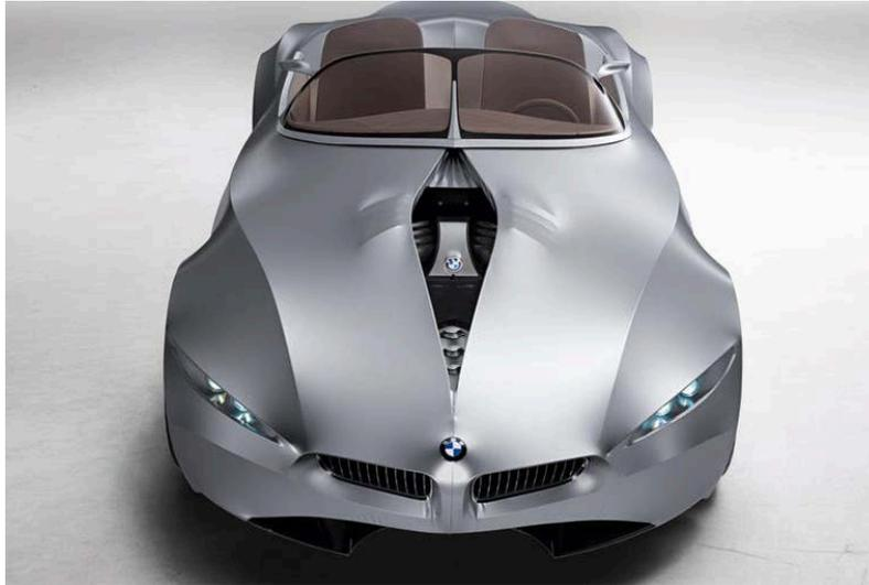
2008 stellte BMW mit der Studie GINA ein vielbeachtetes Konzept zu fugenlosem Design im Fahrzeug-Exterieur vor. Mit Hilfe eines flexiblen Gewebes konnten funktional und fertigungstechnisch begründete Fugen reduziert werden. Aktuelle Designkonzepte greifen vielfach eine solche Gestalt ohne Fugen und Zierstäbe auf. Ziel dieser Arbeit ist, die Möglichkeiten zur Umsetzbarkeit eines fugenlosen Designs im PKW-Exterieur auszuloten.
