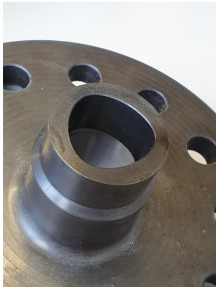
In einem Kooperationsprojekt beteiligt sich das IKTD an der Erforschung von Welle-Nabe-Verbindungen (WNV) mit Naben aus Metall/Keramik-Verbundwerkstoffen. Ausgehend von Pressverbänden wird nicht nur das Materialverhalten an sich, sondern auch das resultierende Verbindungsverhalten statisch und dynamisch untersucht. Die Ergebnisse werden dabei von reibschlüssigen Verbindungen ebenfalls auf Polygon- und Passfederverbindungen übertragen.
