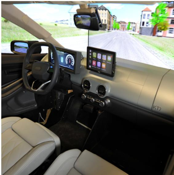
Zur Erprobung verschiedener Designaspekte in Fahrzeugen eignet sich die Verwendung von Simulatoren. Dabei besitzt die Immersion eine zentrale Rolle. Je höher die Immersion im Simulator desto näher kommt das Erleben dem realen Nutzungskontext im Fahrzeug und desto besser lassen sich Interaktionskonzepte und Bedienelemente repräsentativ untersuchen.
